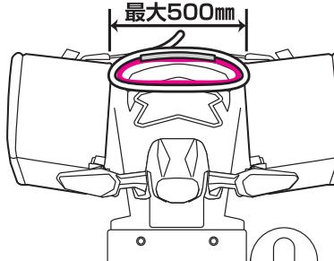
ウインカーやマフラーに接触せずに、バッグが取付ける事が出来るスペースが確保されている事。
