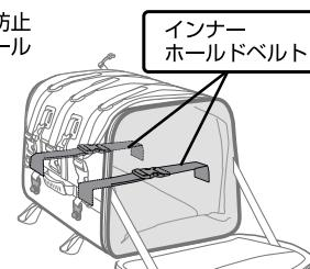
△ 警告 ●固定ベルトの取り回しは、ホイールやチェーン等の可動部分に絶対に接触しないようにしてください。又、余ったベルトは適切に処理してください。
