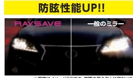
鏡で反射される可視光線の中から「人間の目が眩しいと感じる波長」の光だけを抑えます。
