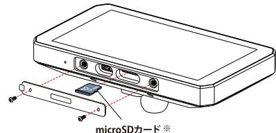
※本製品付属のmicroSDカードもしくは転送速度がU3規格のmicroSDカード(32GB以上)を使用してください。カード挿入時はネジの紛失にご注意ください。
