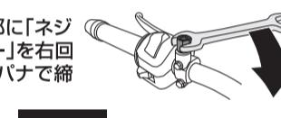
取り付けた「ネジ径変換アダプター」に本製品を取り付け右回りに締め付けます。
