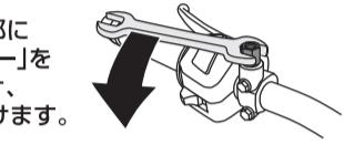
取り付けた「逆ネジアダプター」に本製品をスパナで抑えながら右回りに締め付けます。
