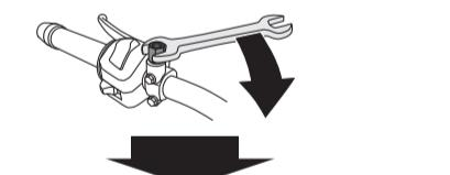
取り付けた「G-3ピッチ変換アダプター」に本製品を取り付け右回りに締め付けます。
