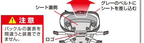
2 シート表側でシート固定用のグレーのベルトを締めてシートに固定してください。グレーのベルトは回転移動できますので、ベルトが引きやすい場所に調整出来ます。
