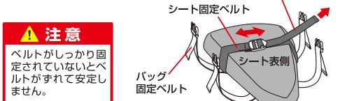
3 シートを戻し、しっかりと車体に固定させます。(この時に固定用のバックルのついた4本のベルトをシートの外に上向きになるように出してください。)
