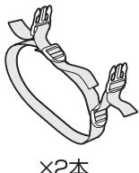
1 シートを取り外し「シート固定ベルト」を図の様に装着します。
