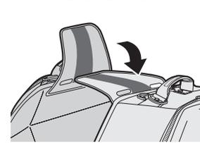
4. 手を差込み、ベルトの長さを調節します。
