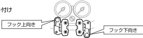
**2** ハンドルクランプを固定している純正ボルトを取り外します。(※外した純正ボルトは使用しませんので大切に保管してください)
