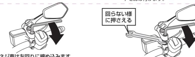
10mm ボルトの締付トルクは正ネジ逆ネジとも 23[N·m] です。
