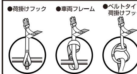
●固定ベルトの取り回しは、ホイールやチェーン等の可動部分に絶対に接触しないようにしてください。又、余ったベルトは適切に処理してください。
