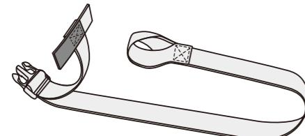
2 固定ベルトを車体に繋げたらバックルをバッグ本体のバックルに接続します。前後左右が均等になるようにベルトの長さを締めて調整します。
