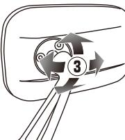
▲ 注意 ミラージョイント部固定ボルト締め付け時の注意
