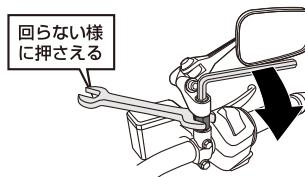
10mm ボルトの締付トルクは正ネジ逆ネジとも 23[N·m] です。
