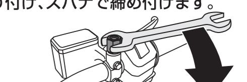
取り付けた「G-3 ピッチ変換アダプター」に本製品を取り付け右回りに締め付けます。
