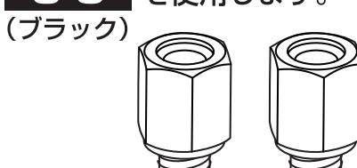
アダプター・キャップボルトの締め付けトルクは 23[N·m] です。
