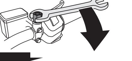
取り付けた「G-3 ピッチ変換アダプター」に本製品を取り付け右回りに締め付けます。
