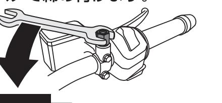
取り付けた「ネジ径変換アダプター」に本製品を取り付け右回りに締め付けます。
