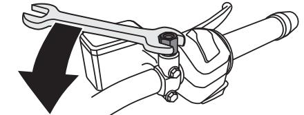
取り付けた「逆ネジアダプター」に本製品をスパナで抑えながら右回りに締め付けます。
