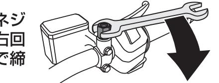
取り付けた「ネジ径変換アダプター」に本製品を取り付け右回りに締め付けます。
