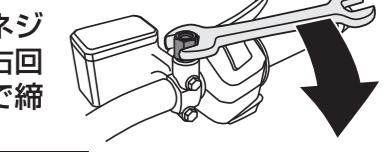
取り付けた「ネジ径変換アダプター」にステーを取り付け左回りに締め付けます。
