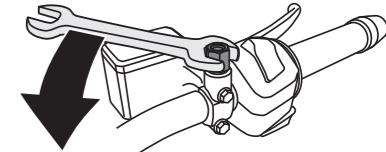
取り付けた「逆ネジアダプター」に本製品のアダプターをスパナで抑えながら右回りに締め付けます。
