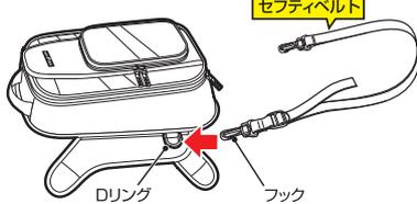
**2** ハンドル操作に影響の無い所へセフティベルトを回し、緩みの無い様に長さを調節して、フックをもう片方のDリングに固定します。
