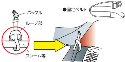
2 バッグの位置に合わせて固定ベルトのバックルを、バッグに接続しベルトの長さを調整します。固定ベルトは左右均等に適度なテンションをかけてください。吸盤はしっかりと貼り付けてください。
