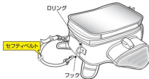
2 オートバイのステアリングヘッドに右図の様にセフティベルトをまわし、緩みのないように長さを調整して、フックをもう片方のDリングに固定します。
