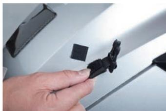
ベルト止めストッパーのベルクローを車両側にはりつけて固定ベルトが落ちないように止めておくことができます。
