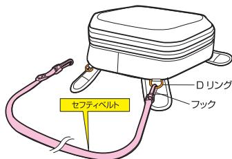
2 オートバイのステアリングヘッドに下図の様にセフティベルトをまわし、緩みのないように長さを調節して、フックをもう片方のDリングに固定します。
