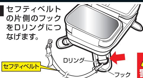
2 オートバイのステアリングヘッドに右図の様にセフティベルトをまわし、緩みのないように長さを調節して、フックをもう片方のDリングに固定します。
