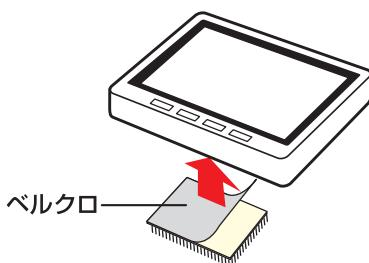
2 1のナビゲーションをバッグに貼り付けます。(ナビゲーションが薄い場合、付属のスペーサーを使用して下さい。)
