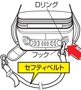
2 オートバイのステアリングヘッドに下図の様にセフティベルトをまわし、緩みのないよう長さを調節して、フックをもう片方のDリングに固定します。
