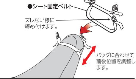
2. バッグの位置に合わせて「シート固定ベルト」の位置を決めシートに固定し、左右均等に、適度なテンションにベルトの長さを調節します。
